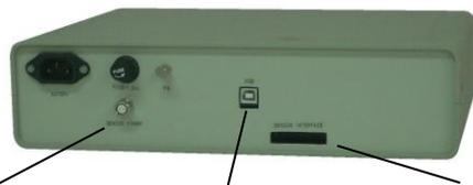
センサ用電源出力 USB インターフェース センサ入力(LVDS)
