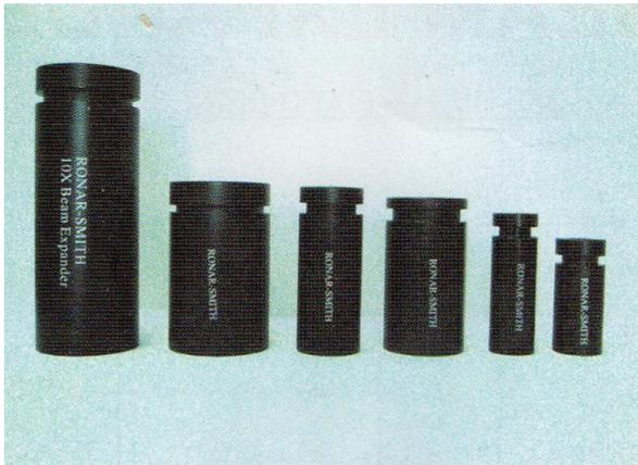
■ビームエキスパンダーは、レーザーのビーム径を拡大する際に使用します。拡大されたビームは、ビーム径の拡大倍率に反比例して、ビーム拡がり角が縮小されますので、より小さなスポットに集光することが可能になります。
