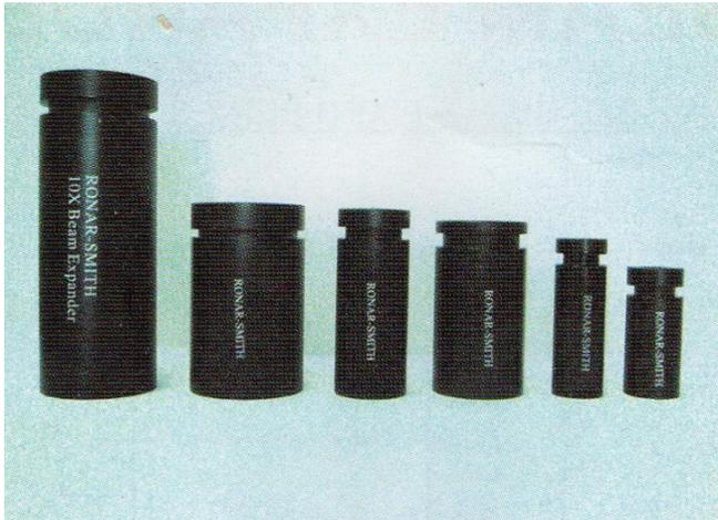
■ビームエキスパンダーは、レーザのビーム径を拡大する際に使用します。拡大されたビームは、ビーム径の拡大倍率に反比例して、ビーム拡がり角が縮小されますので、より小さなスポットに集光することが可能になります。
