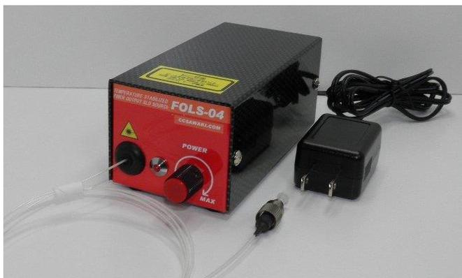
FOLS-04は出力SMファイバ・SLD素子・駆動回路・温度制御回路・電源を一体化した、スーパーluminescent光源です。
