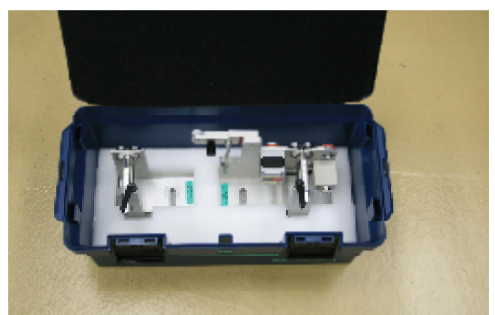
シャフトに対応したベアリング間隔とワーク測定位置(高さ)を同じにする為、間隔に応じた高さを検討し製作します。
