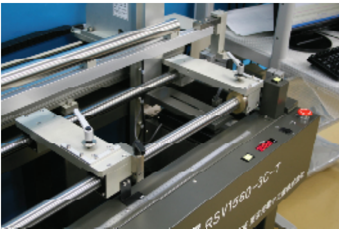
交換はレバーにて簡単に着脱
